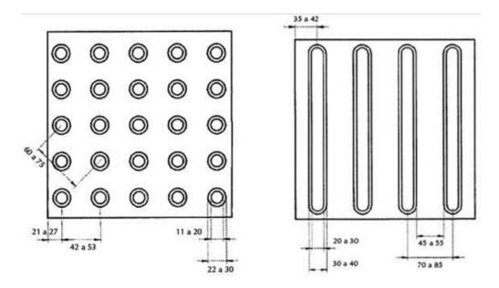
dimensões em mm - fonte: NBR 9050
